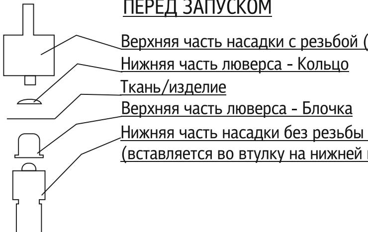
**Порядок работы с прессом ТЕР-1 универсальным на примере установки люверсов (с помощью данного пресса можно устанавливать любую фурнитуру):**
